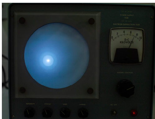
Slika 2. Apartura za vežbu Difrakcija elektrona
