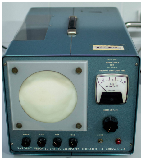
Slika 2. Apartura za vežbu Difrakcija elektrona
