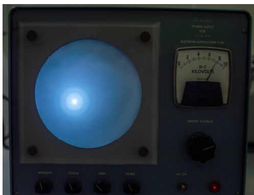
Slika 3. Difrakcione slike za različite ubrzavajuće napone
