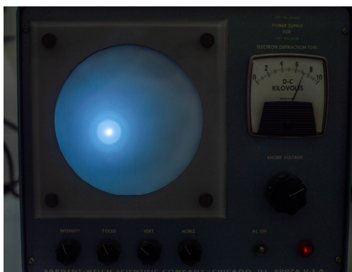
Slika 2. Apartura za vežbu Difrakcija elektrona
