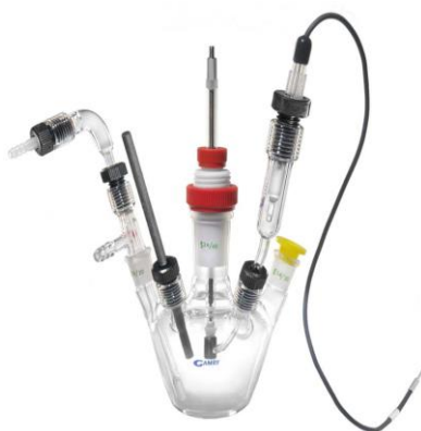
Slika 2. Realna troelektrodna ćelija
