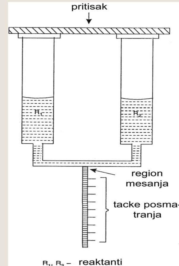
*Slika 1.* Aparatura za merenje kinetičkih parametara protočnom metodom.
