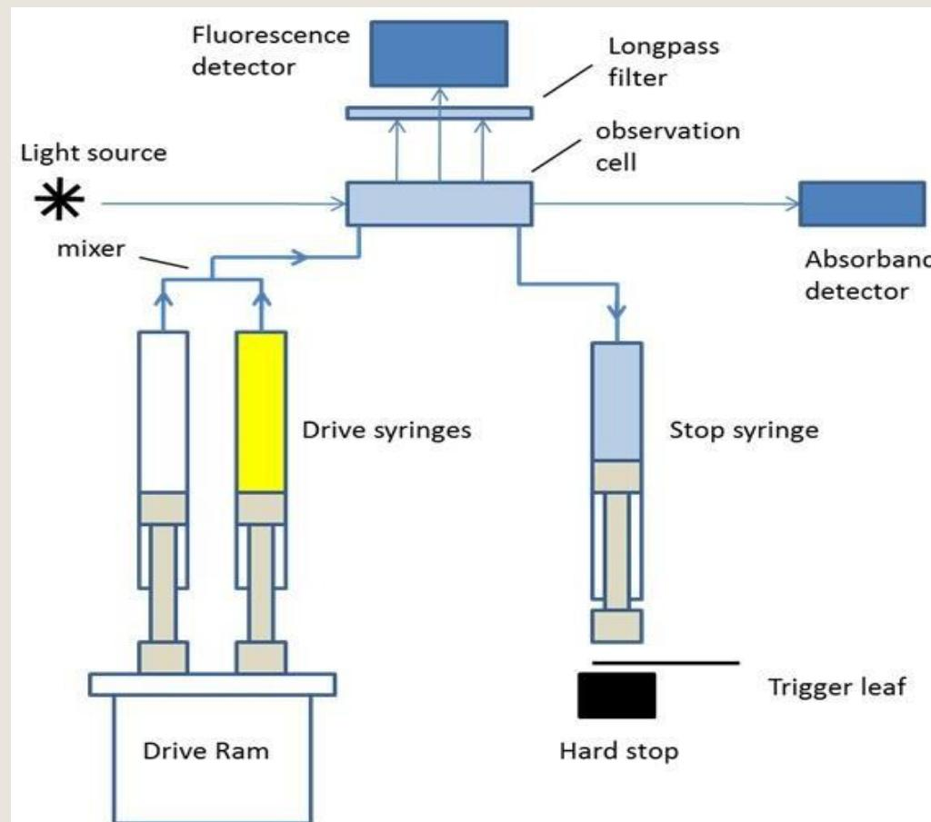
Slika 2. Aparatura za eksperimente sa zaustavljenim protokom
