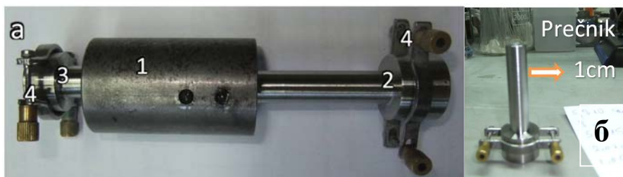
Слика 2. (а) Калуп за мерење електричне проводљивости 1-шупљи цилиндар (израђен од нерђајућег челика, а са унутрашње стране обложен изолаторском тврдом пластиком), 2-већи и 3-мањи цилиндрични клип од нерђајућег челика, 4 – положаји на клиповима где се постављају штипаљке каблова од Вистоновог моста; (б) већи клип пречника, d_1 = 1 \text{ cm} .
