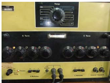
Слика 4. Вистонов мост (Wayne Kerr B224)
