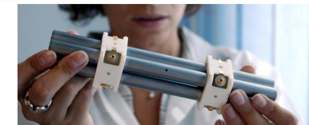
Šematski prikaz kvadrupolnog detektora.
