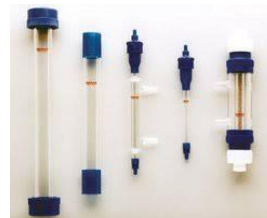
Izgled kolona za tečnu hromatografiju (5-25 cm, prečnik od 3 do 5 mm).
