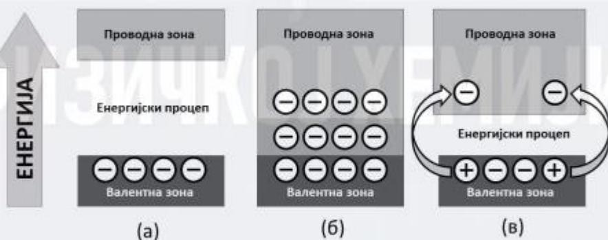
Слика 10: Шематски приказ енергијских зона и процепа код: (а) Диелектрика; (б) Проводника; (в) Полупроводника.
